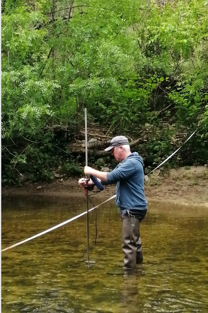
**PHOTO 10 - Les réseaux de suivi hydrométrique et piézométrique, outils essentiels de gestion - Mesure de débit par l'EPTB**
