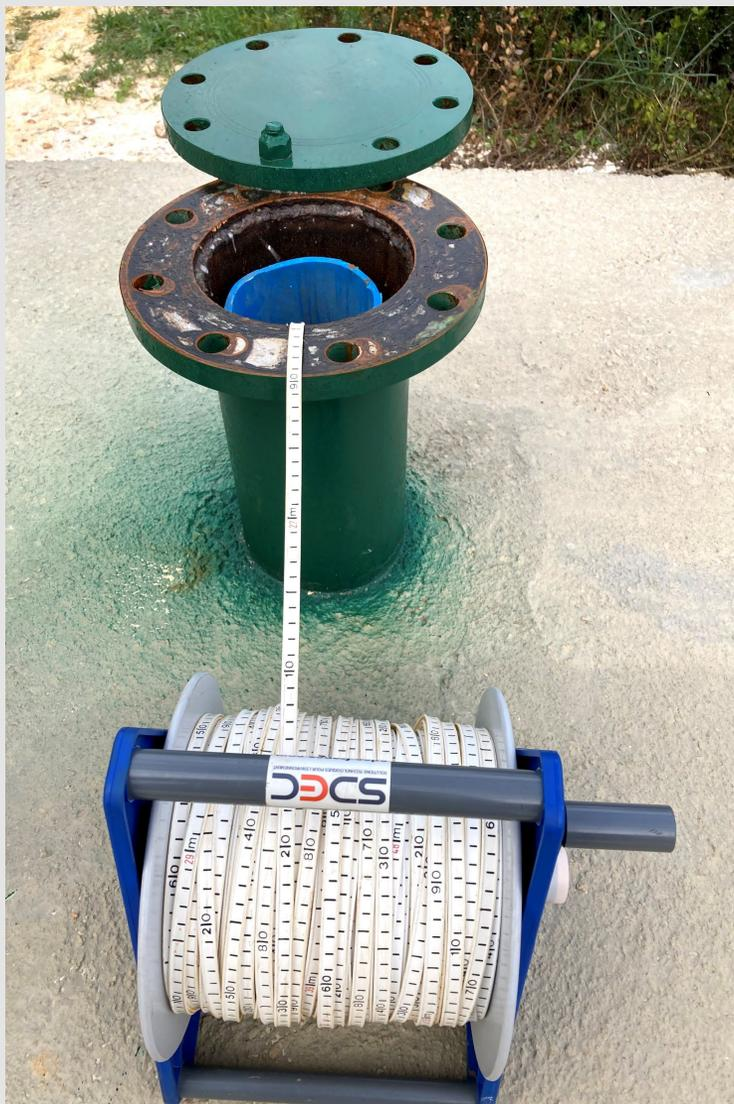
**PHOTO 11 - Les réseaux de suivi hydrométrique et piézométrique, outils essentiels de gestion - Un piézomètre**
